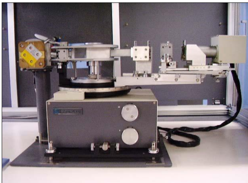
FIGURA 3. Aspecto del difractómetro marca RIGAKU modelo D/MAX IIIB. Laboratorio de Difracción de Rayos X. Escuela de Química, UIS.
