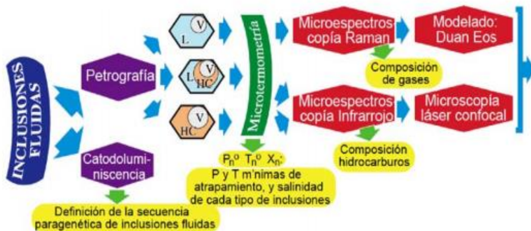
Ilustración 3. Diagrama de técnicas espectrométricas a partir de las IF. Tomado de Levresse et al., 2006.
