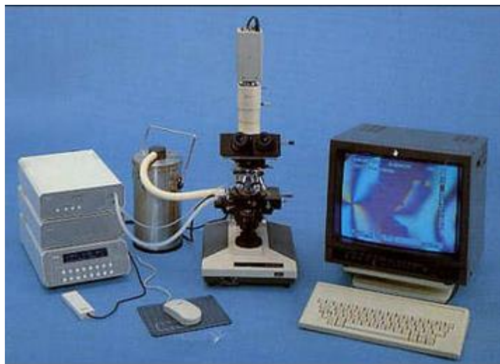
Ilustración 12. Modelo general de los equipos de inclusiones fluidas y vítreas. Tomada de Universidad de Oviedo.
