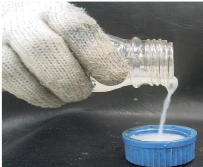
Figura 52. Fluido de fractura roto a condición estática (110°C)
