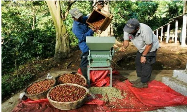
Fotografía 1 Versión manual de la maquina despulpadora
