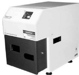
Figura 6. Instrumento portátil LIBS (Tracer 2100) desarrollado por Advanced Power Technologies Inc.
