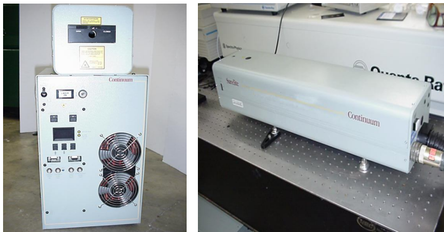
Figura 11. Izquierda: Equipo completo constituido por el láser (superior) y la fuente de láser (inferior). Derecha: láser visto desde otro ángulo.
