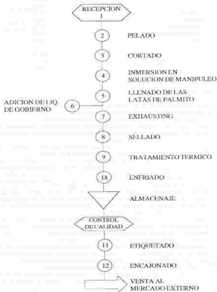
Flujograma de procesamiento para la obtención de conservas de palmito
