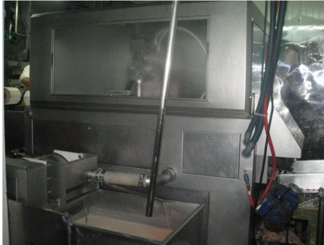
Foto 24. Máquina inyectora de producto
