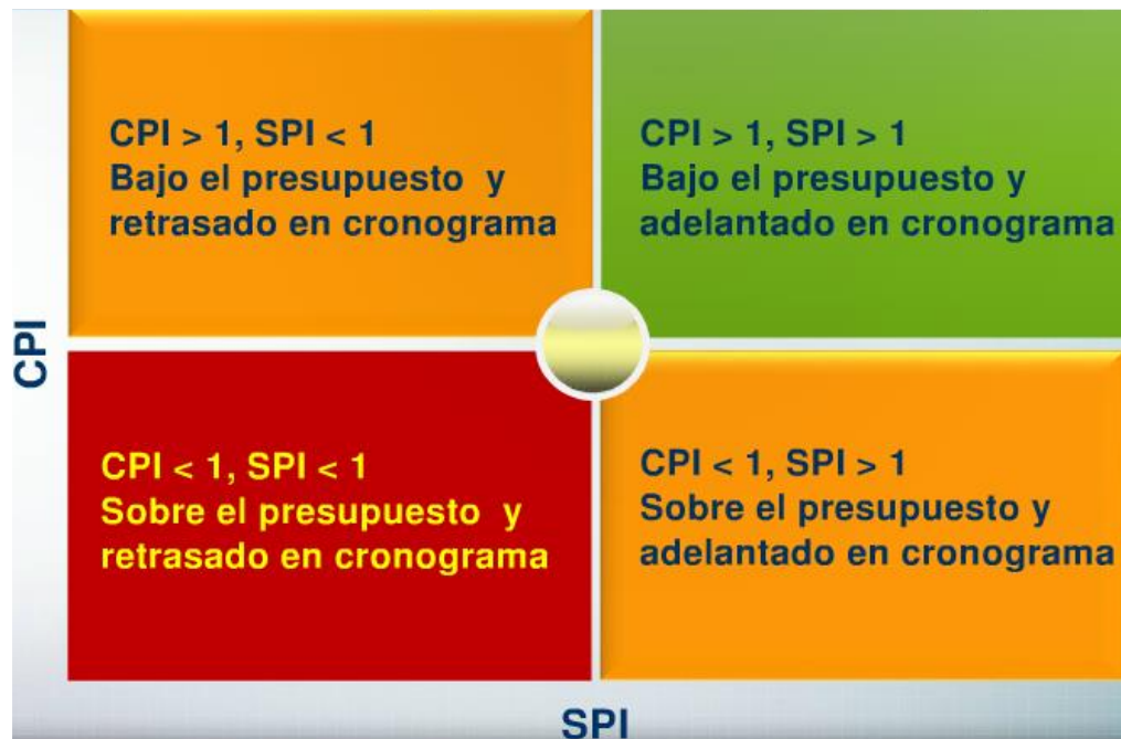
Figura 4. Tablero de Control EVM.
