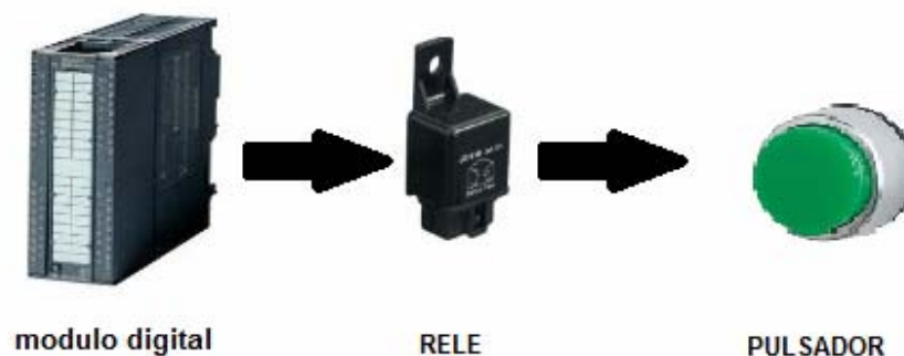
Figura 81: Flujo eléctrico on/off motor.
