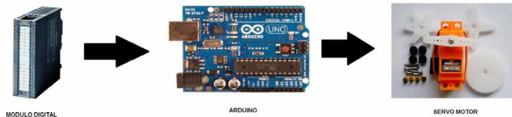
Figura 80: Flujo eléctrico accionamiento servomotor.
