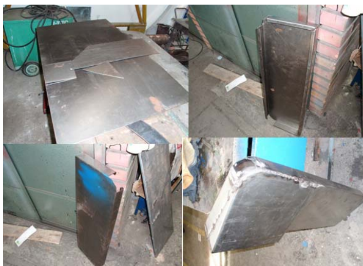
Figura 74: Proceso fabricación panel de control.
