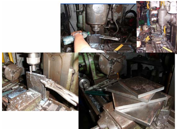
Figura 60: Maquinado de las paredes de la caja inversora.
