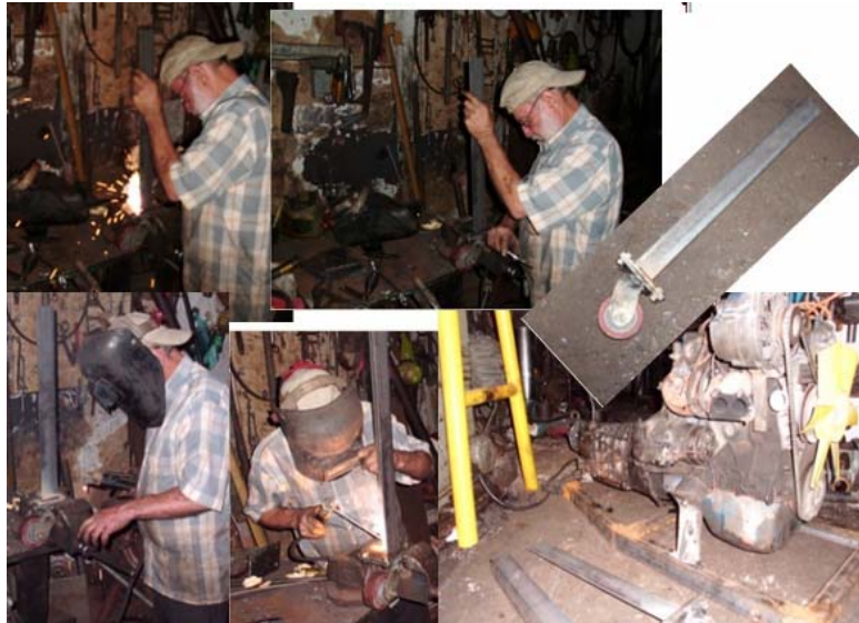
Figura 55: Construcción de las patas de la base.
