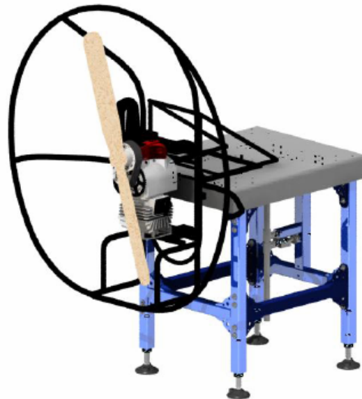
Figura 3: Banco de pruebas para motores de ultraliviano.
