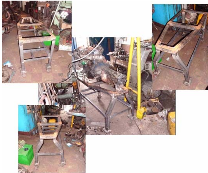
Figura 56: Base terminada y prueba estática con el motor.
