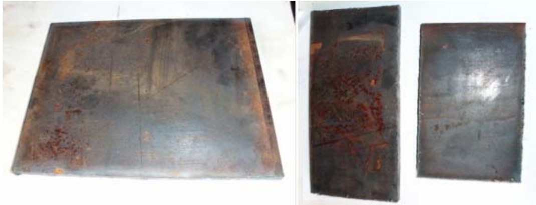
Figura 59: Laminas 3/8" estructura externa del inversor de giro.
