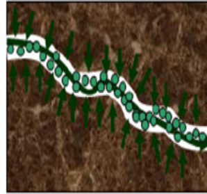
Flujo de gas libre en el sistema de fracturas
