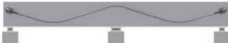
Figura 12: Esquema de cable en hormigón postensado
