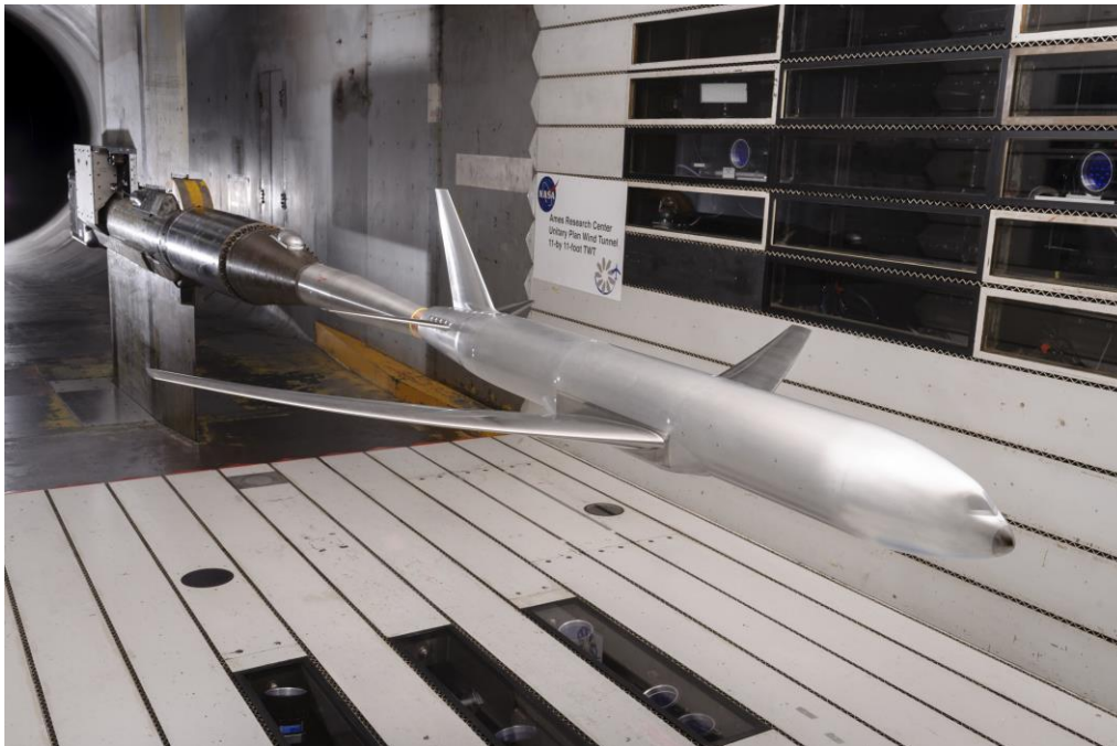
Figura 6. Diseño de un avión a escala en un túnel de viento. Adaptado de la página oficial de la NASA. (Aldenbrook, 2016)
