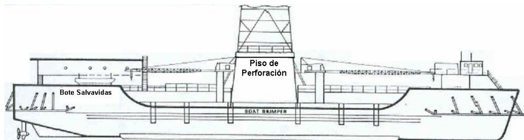
Figura 13. Piso de perforación.
