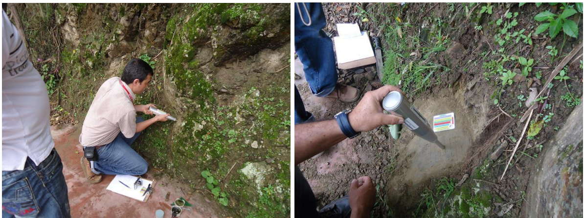
Figura 58. Realización pruebas con el martillo Schmidt.
