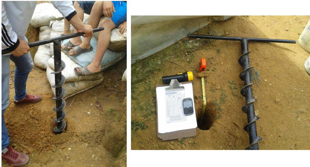
Figura 57. Prueba de infiltración, método de Porchet del pozo barrenado invertido.
