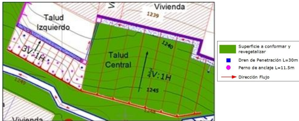
Figura 87. Conformación de la superficie de los taludes (Sin escala).
