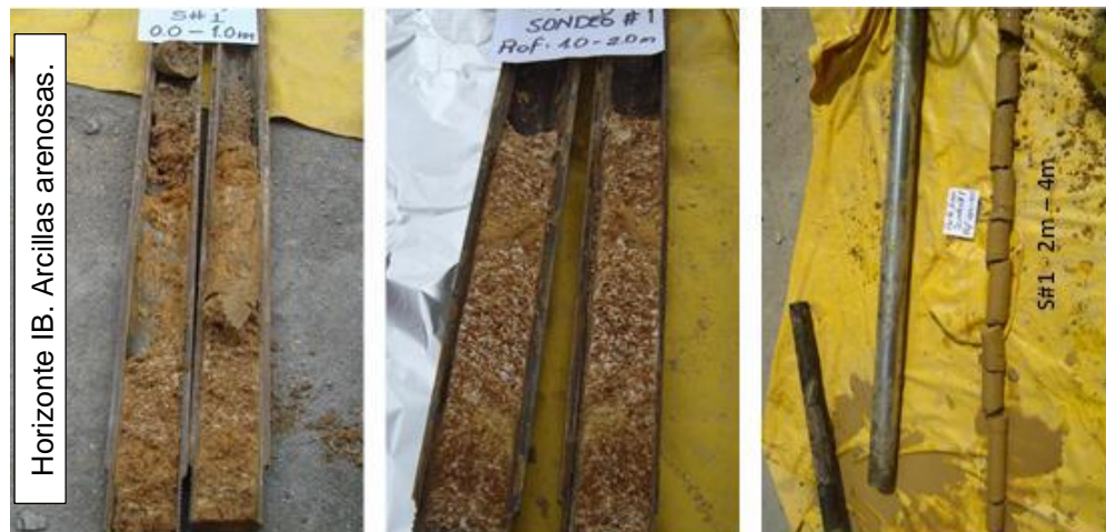
Figura 42. Muestras obtenidas en el Sondeo No.1.
