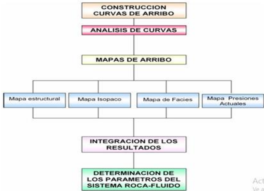
Figura 8 Fase de Interpretación de resultados en una Prueba de Trazadores entre Pozos. Adaptado de Orlando & López 2006. Metodología para el diseño y evaluación de pruebas de trazadores entre pozos como herramienta complementaria en la caracterización de yacimientos.
