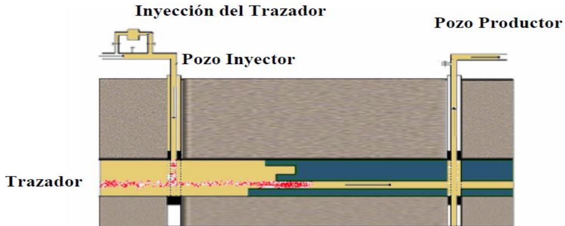
Figura 5. Flujo Esquemático de los Trazadores en el Yacimiento. Adaptado de Orlando & López 2006. Metodología para el diseño y evaluación de pruebas de trazadores entre pozos como herramienta complementaria en la caracterización de yacimientos.
