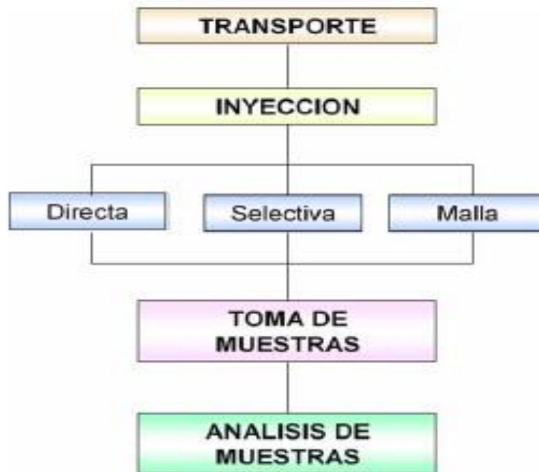
Figura 7. Fase de ejecución en una prueba de trazadores entre pozos adaptado de Orlando & López 2006. Metodología para el diseño y evaluación de pruebas de trazadores entre pozos como herramienta complementaria en la caracterización de yacimientos.
