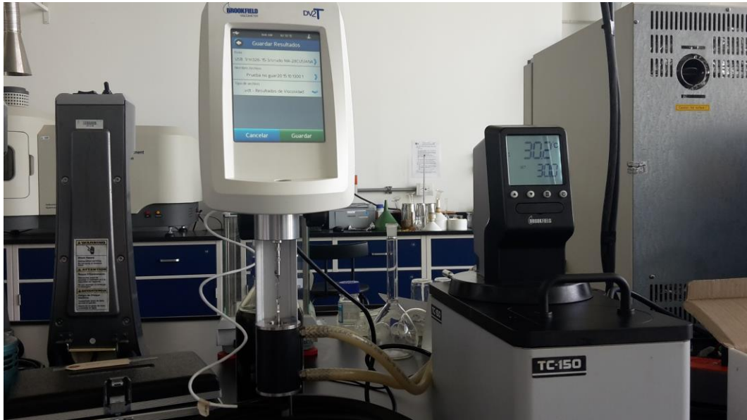
Figura 2. Medición de la viscosidad del aceite
