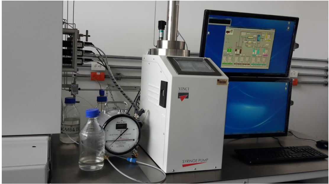
Figura 4. Realización de la prueba de desplazamiento
