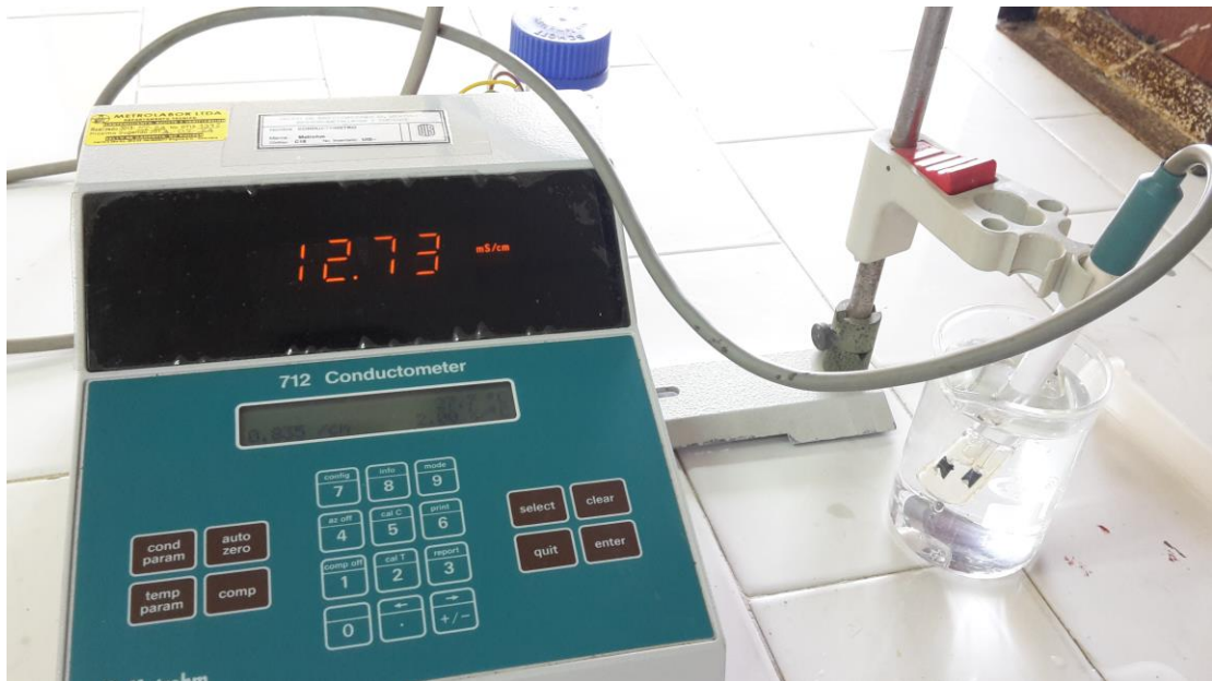
Figura 3. Medición de las propiedades de la salmuera.
