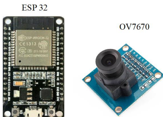
Figura 6. Elementos de hardware para la adquisición y transmisión de imagen.
