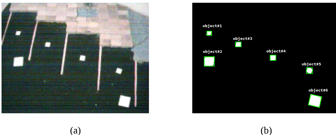
Figura 2. En (a) se pueden ver los objetos a calcular la relación px/m . En (b) se pueden ver los mismos objetos etiquetados. La toma se realiza con la cámara OV7670, con resolución de 320 \times 240 \text{ px} .
