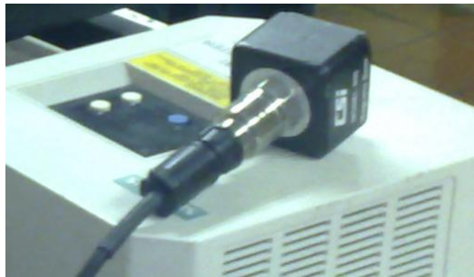
Figura 35 Acelerómetro Base Magnética
