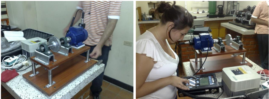
Figura 45 Toma de medición frecuencia natural montaje completo
