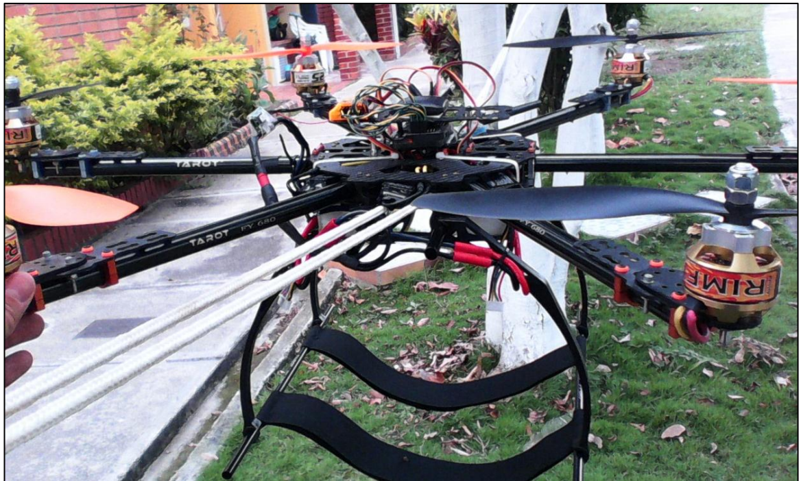
Figura 95. Hexarotor Suspendido por medio de cuerdas para pruebas
