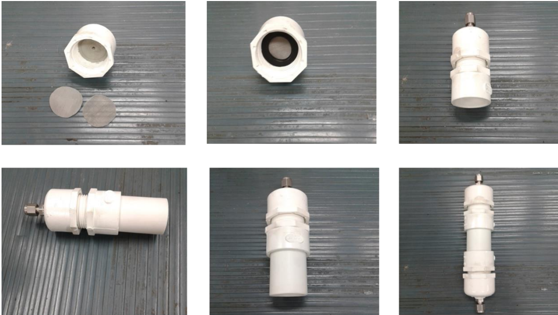
Figura B-1. Construcción del contenedor de la mezcla arena/arcilla
