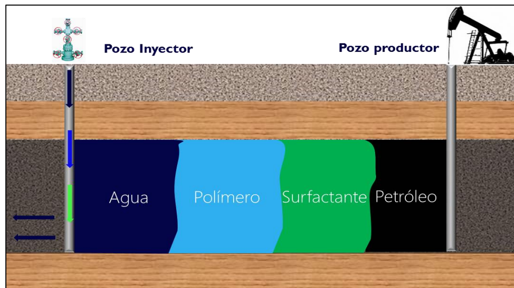
Figura 3. Proceso de inyección de surfactantes.
