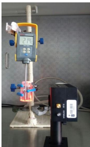
Figura 24. Montaje experimental para la irradiación de las soluciones de AgNPs con y sin funcionalización.
