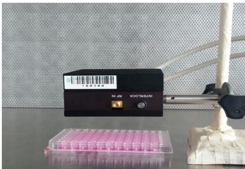
Figura 25. Montaje experimental dentro de una cabina de flujo laminar para la irradiación con IRC de las células tratadas con AgNPs funcionalizadas y sin funcionalizar obtenidas mediante los tres sistemas micelares propuestos.
