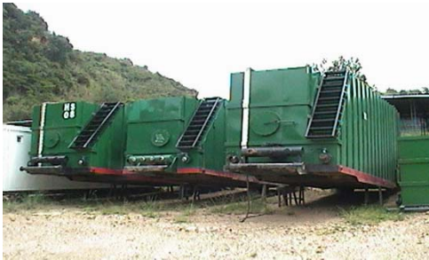
Figura 1. Tanques tipo frac tank
