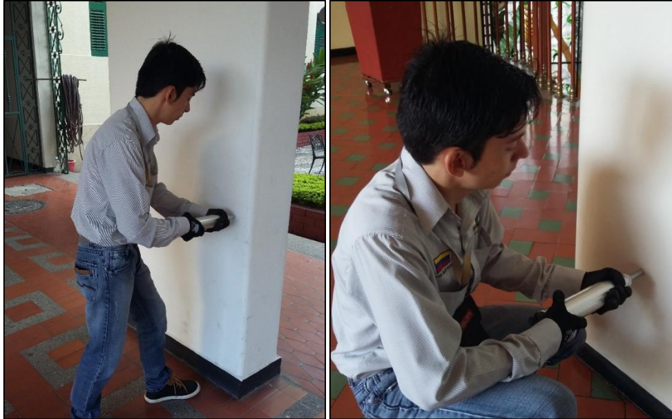
Figura 20. Ensayo de esclerómetro
