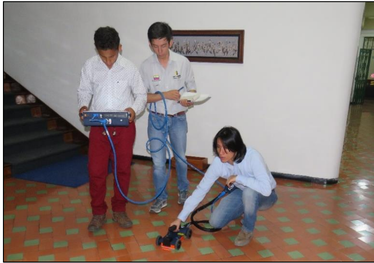
Figura 24. Inspección Geo-Radar Estructural en losa
