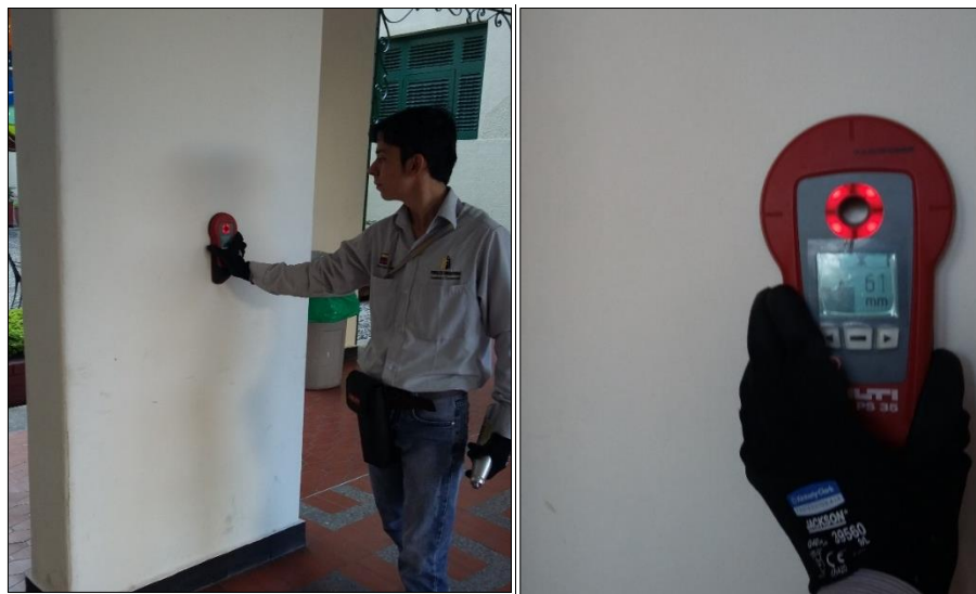
Figura 26. Inspección Ferrodetector Hilti PS-35
