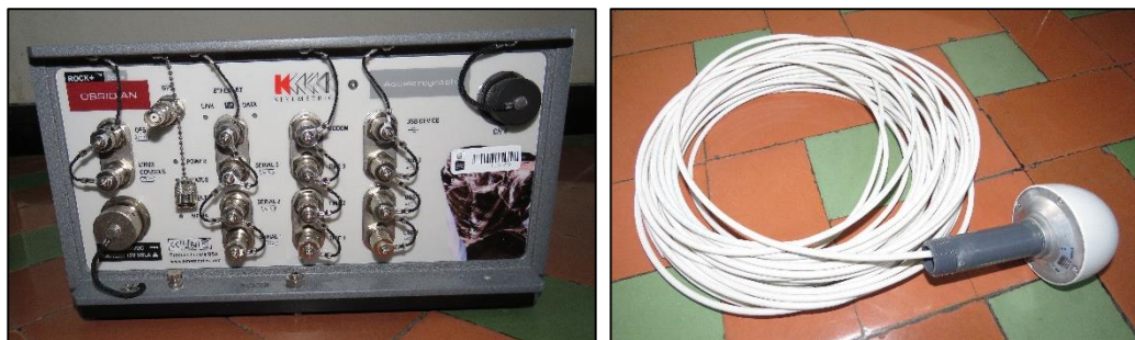
Figura 27. Sistema de adquisición de datos multicanal
