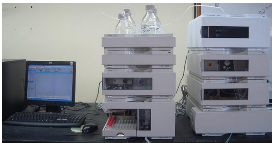
Figura 10. Cromatógrafo líquido de alta eficiencia, (Agilent Technologies serie 1100) y detector de índice de refracción (Agilent Technologies 1200)
