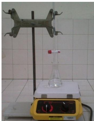
Figura 8. Montaje determinación volumétrica de jabones.
