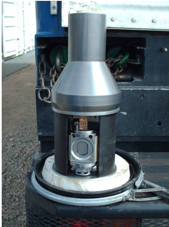
Figura 40 Detalle del Transductor y Sub Rotario.
