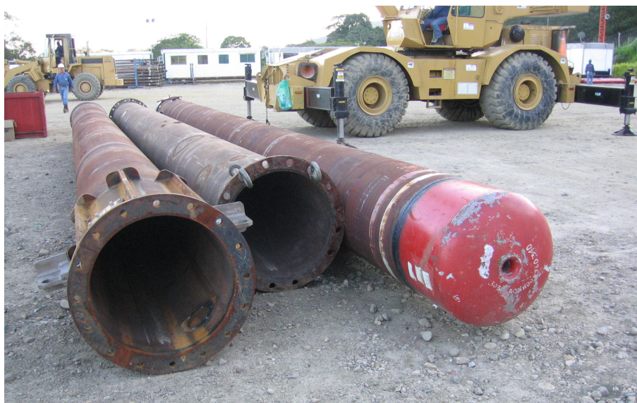
Figura 12 Revestimiento conductor de superficie 30" con zapato guía.
