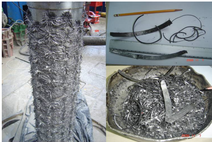
Figura 23 Recortes de metal recuperados con magneto del fondo del pozo.
