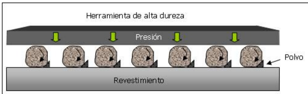
Figura 24 Desgaste de revestimiento por pulido.
