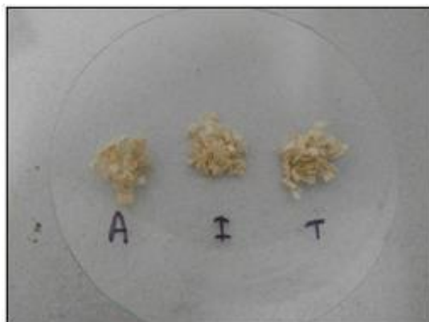
Figura 11. Composito después de los procesos de lavado para determinar la estabilidad química con Agua, Isooctano y Tetrahidrofurano.
