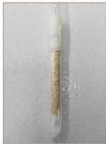
Figura 13. Columna de desulfuración preparada con el compuesto final.
