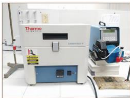
Figura 15. Proceso de desulfuración mediado con temperatura en horno
