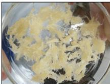
Figura 9. Fibras de celulosa con [BMIM][Cl] (composito final).
