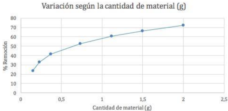
Figura 25. Efecto de la cantidad de material vs Porcentaje de remoción de azufrados de la solución patrón.
