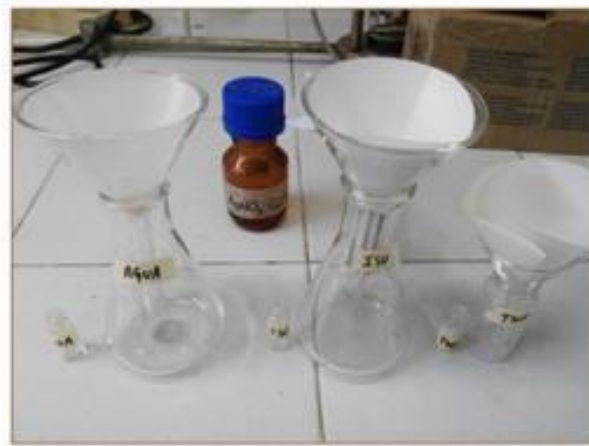
Figura 10. Procedimiento de filtrado para la prueba de estabilidad frente a diferentes solventes
