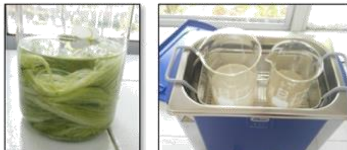
Figura 5. a) Fibras iniciales en agua destilada, b) Bañor ultrasonido
