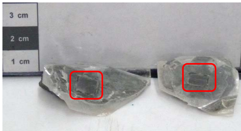
Figura 68. Muestras con epóxico en las áreas demarcadas
