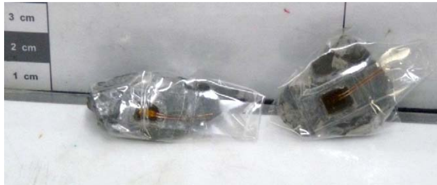
Figura 69. Strain gages adheridos a la superficie demarcada
