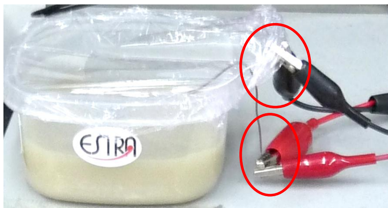
Figura 73. Conexión de los cables al strain gage
