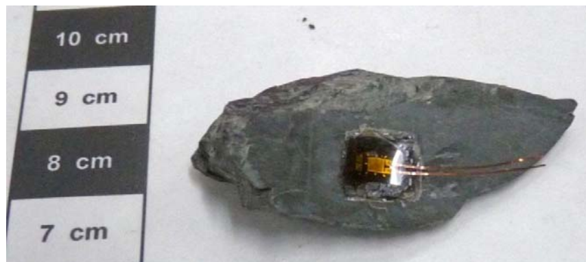
Figura 70. Strain gage adherido, sin ninguna protección
