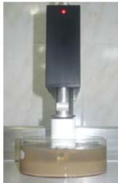
Imagen 1: Probeta deshecha en agua durante la prueba LSM.
