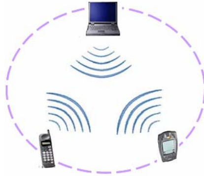
Figura 3. WLAN en modo Ad Hoc
