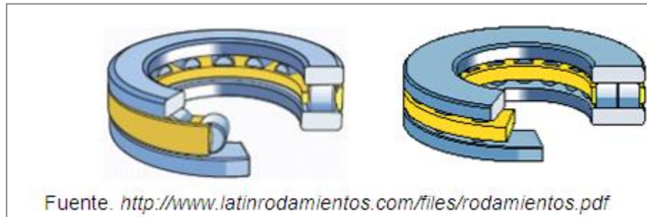
Figura 6. Tipos de rodamientos axiales de rodillos cilíndricos.
