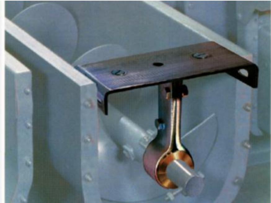
Figura 19. Ejemplo de un cojinete en un tornillo sin fin.
