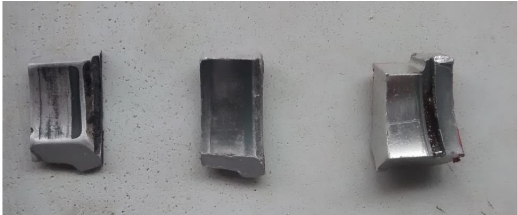
FIGURA 29. Muestras para conformar en baquelita
