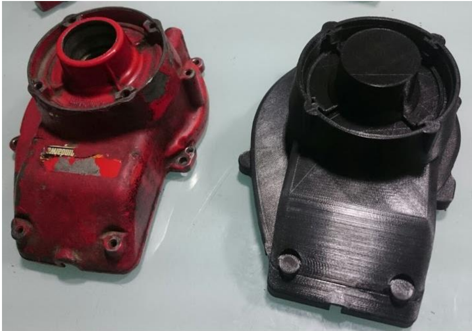
FIGURA 62. Modelo de fundición por impresión en 3D de la carcasa (Material PLA)
