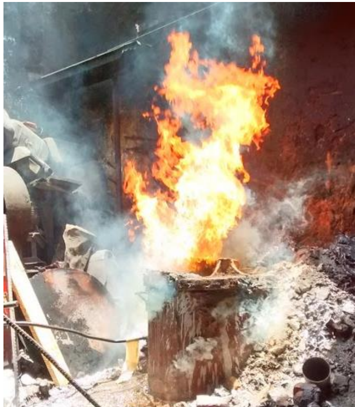
FIGURA 58. Horno fundiendo aleación Al-Si
