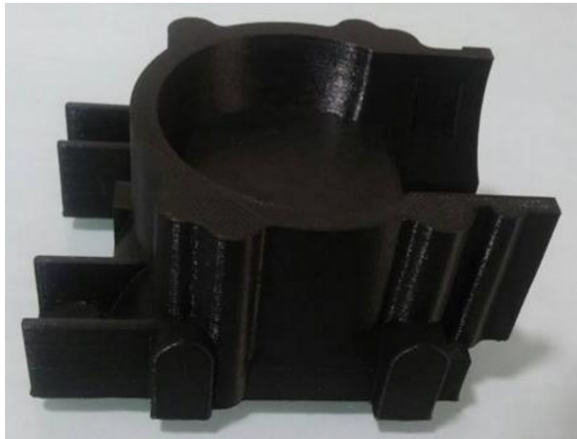
FIGURA 60. Modelo de fundición por impresión en 3D de la sección pequeña del cárter (material PLA)
