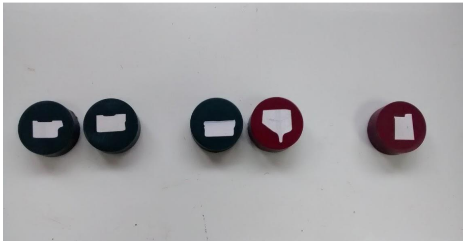
FIGURA 16. Muestras para ensayo de microdureza
