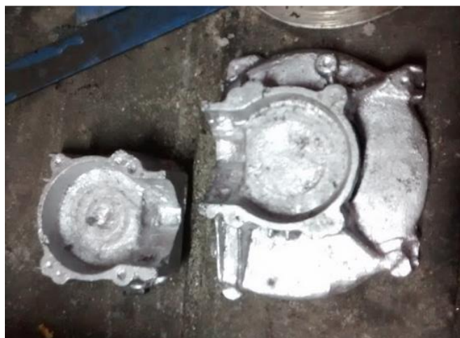
FIGURA 65. Piezas del cárter después del proceso de fundición en arena
