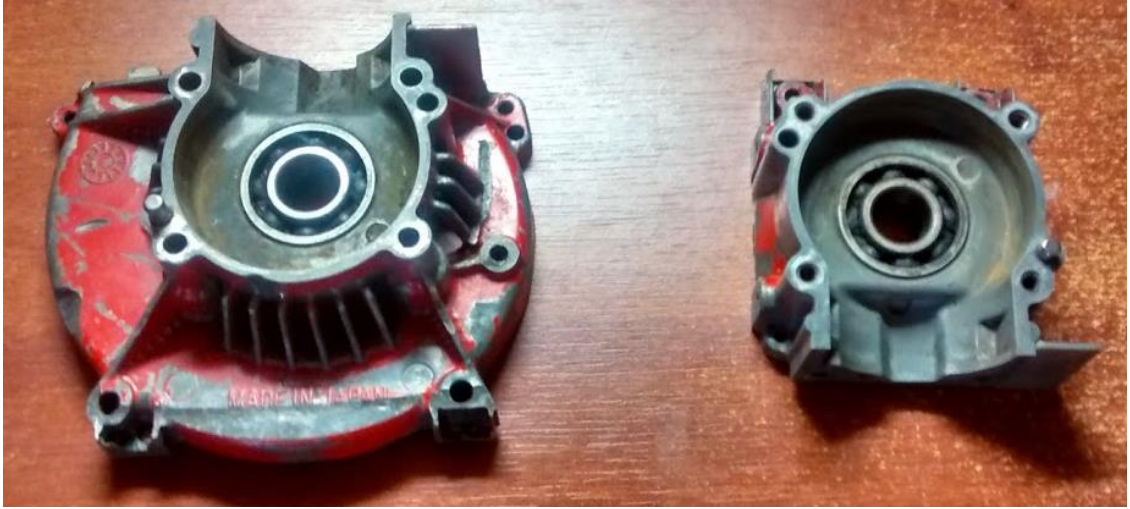
FIGURA 28. Piezas del cárter originales
