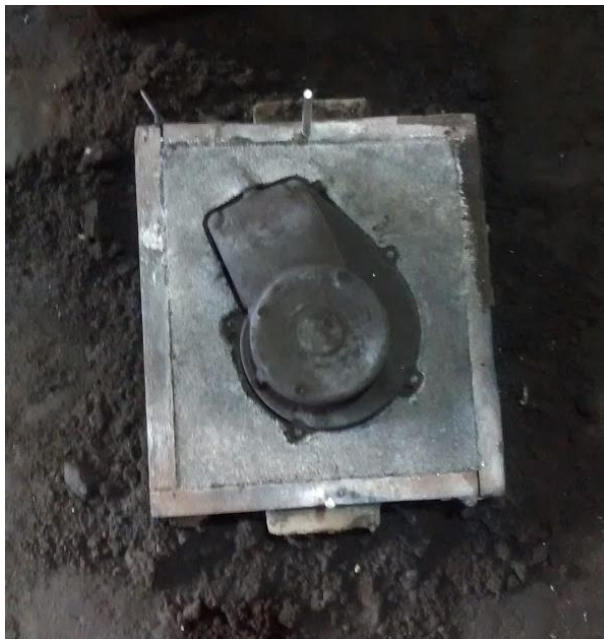
FIGURA 63. Molde en arena para la elaboración de la carcasa
