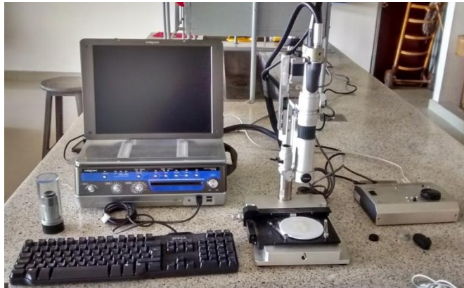
Microscopio Hirox para medir rugosidad
