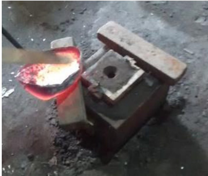
FIGURA 64. Vertimiento de la colada en el molde
