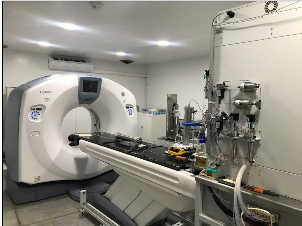
Figura 17. Sistema integrado de inyección de fluidos y escáner TAC 700-CT.
