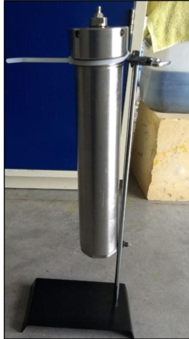
Figura 16. Coreholder de Titanio, usado para confinar núcleos con el fin de obtener atenuaciones bajas de rayos X en la representación gráfica generada.
