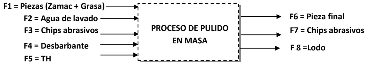
Figura 2. Diagrama de flujo del balance de masa del proceso
