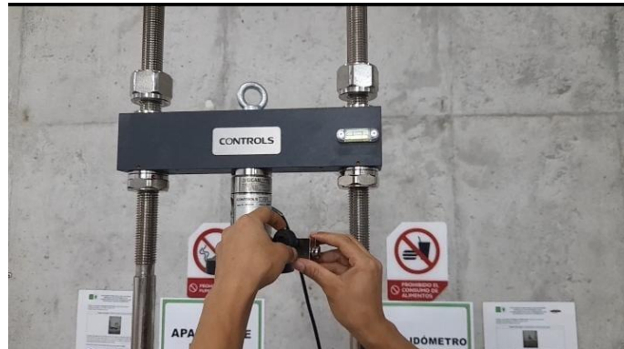
Figura 5. Ajuste cabezal soporte del deformímetro
