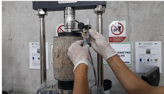
Figura 8. Desmote del deformímetro
