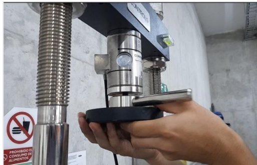
Figura 3. Ajuste del disco superior
