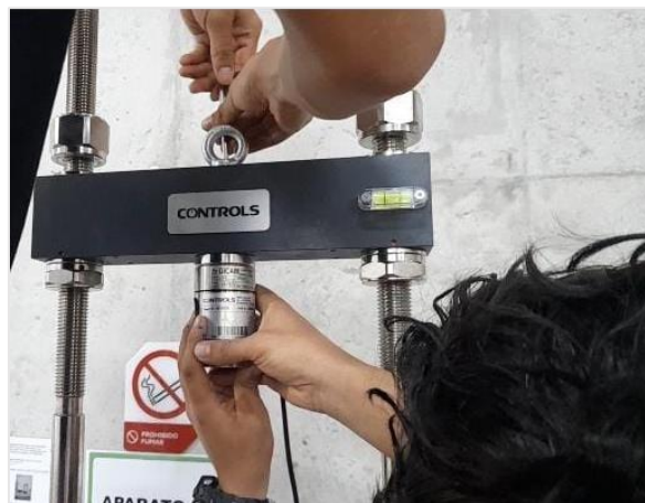
Figura 1. Montaje de la celda de carga
