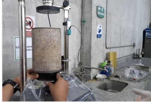
Figura 4. Montaje de la probeta en la máquina.
