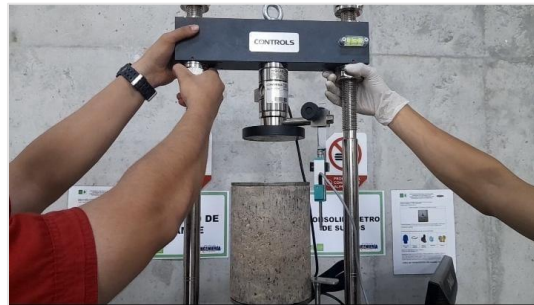
Figura 5. Ajuste del cabezal superior
