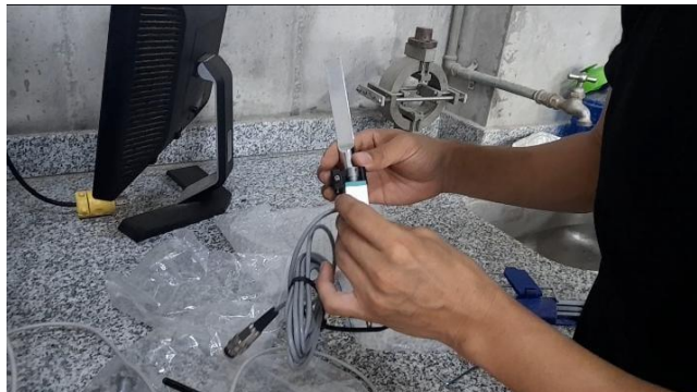
Figura 6. Montaje del deformímetro en el soporte
