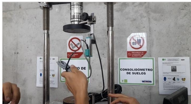
Figura 8. Montaje del soporte en el brazo.
