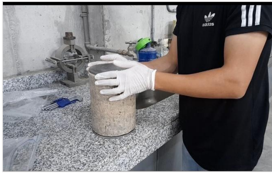
Figura 3. Montaje de probeta en los discos
