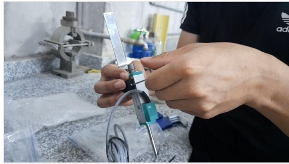
Figura 7. Ajuste del deformímetro
