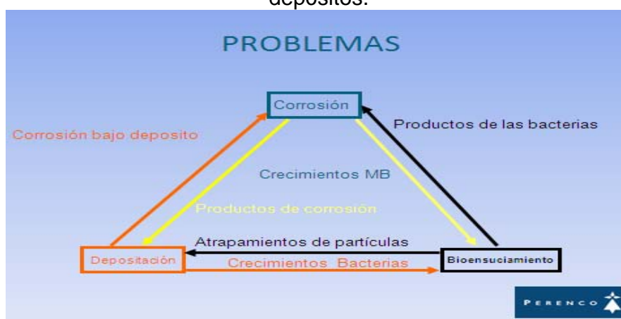
Figura 1. Influencia del bioensuciamiento con la corrosión y la formación de depósitos.
