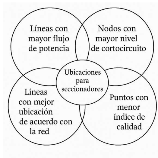
Ilustración 4. Esquema de análisis de ubicación para seccionadores.
