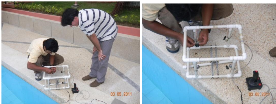
Figura 111. ROV Marco en tubo de PVC.
