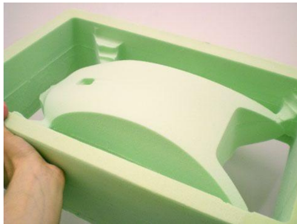
Figura 27. Modulo de flotabilidad fundido en espuma rígida de poliuretano y mecanizado en una estación CNC
