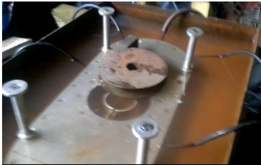
Figura 124. Montaje de prueba hidrostática.
