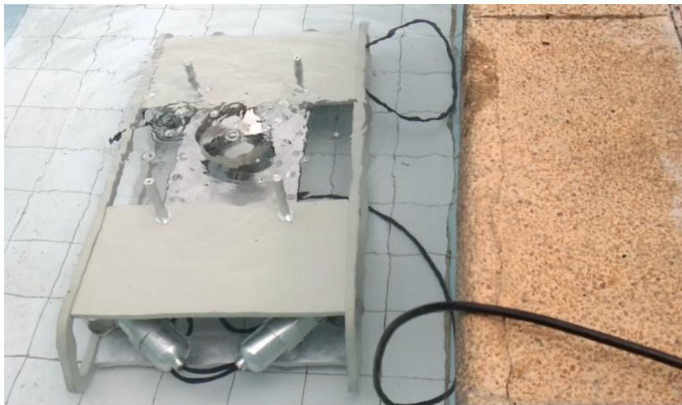
Figura 128. Prueba de hermeticidad y encendido de motores.
