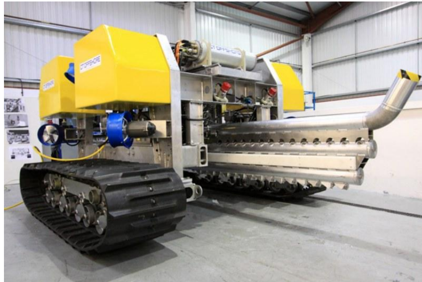
Figura 23. Equipo representativo ROV de trabajo pesado para empresa Sub Atlantic.
