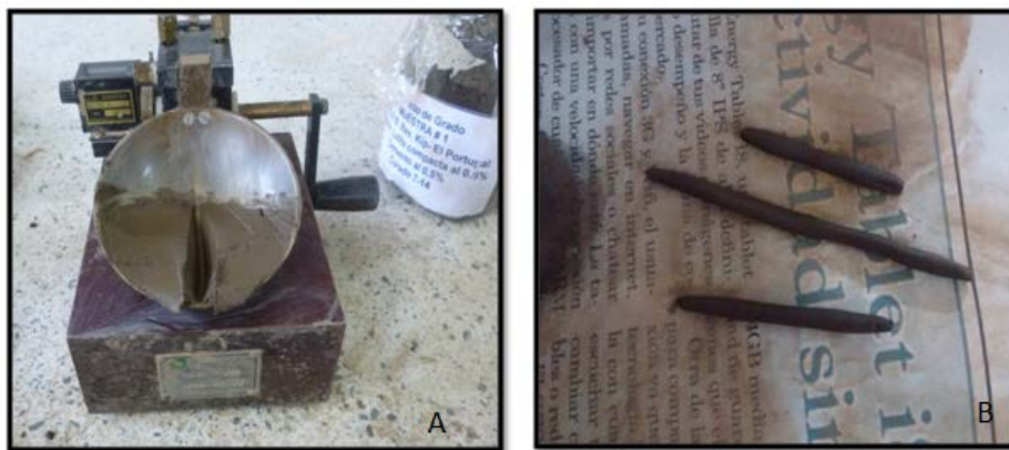
Figura 3. Aparato de Casagrande para le determinación de LL (A), moldes de 3 mm de diámetro para determinar LP (B).
