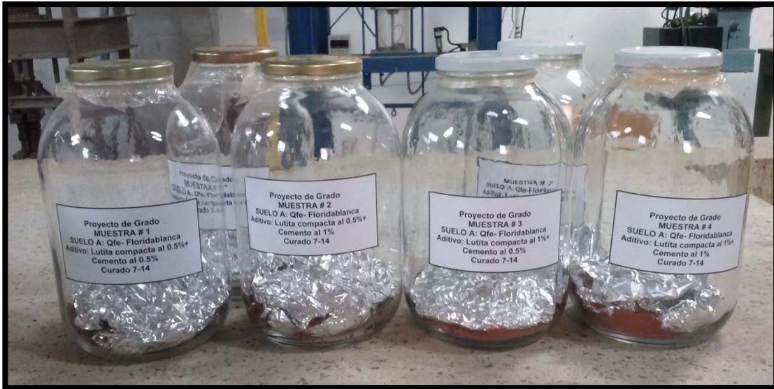
Figura 30 Muestras de suelo aditivadas dispuestas al tiempo curado.
