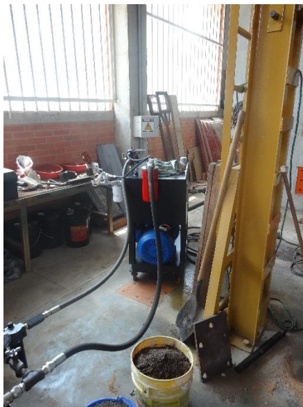
Figura 21 Unidad de potencia hidráulica para mesa sísmica
