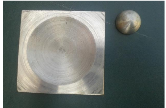
Figura 13 Vista en planta de 1 aislador construido.
