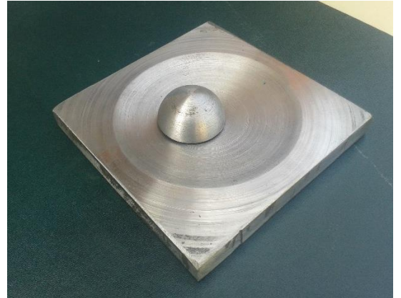
Figura 14. Aislador terminado (Superficie cóncava y deslizador)
