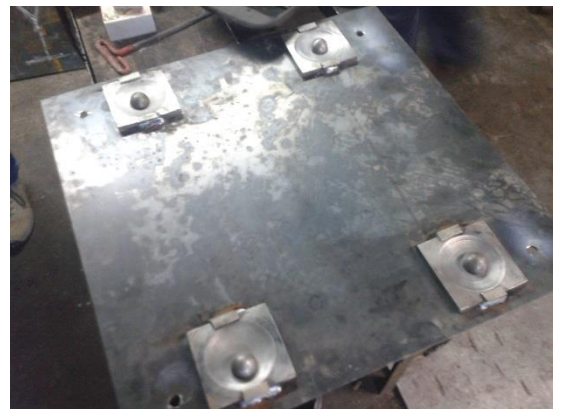
Figura 15. Montaje final de los 4 aisladores
