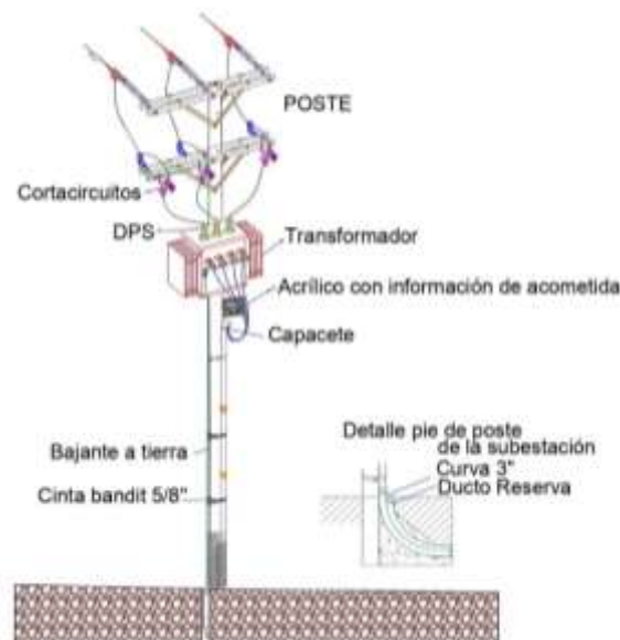
Figura 2. Acometida de una provisional de obra eléctrica
