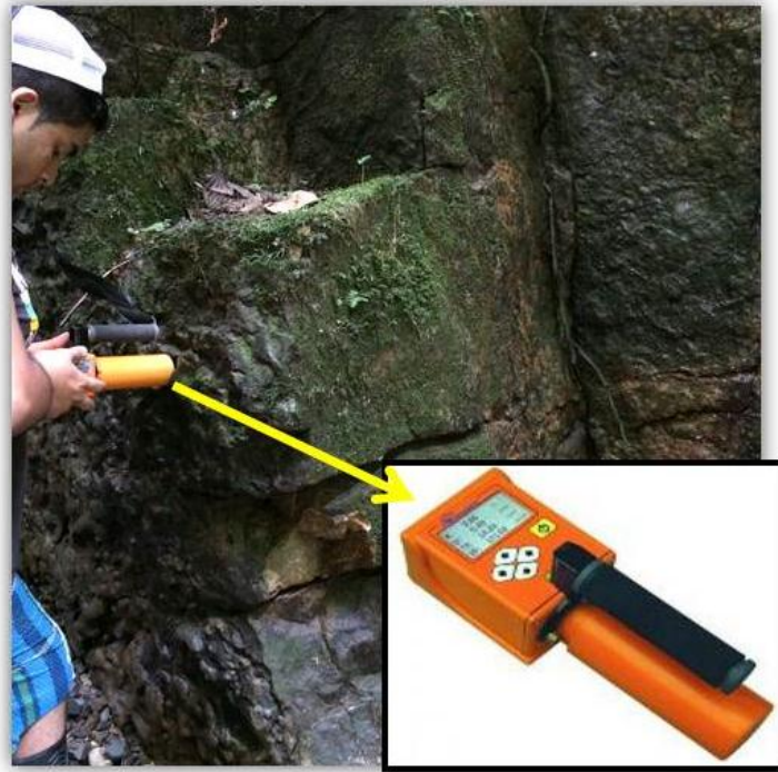
Figura 24. Gamma ray espectral (propiedad del ICP), determinando concentraciones de elementos radiactivos naturales (K, U, Th), utilizado en campo
