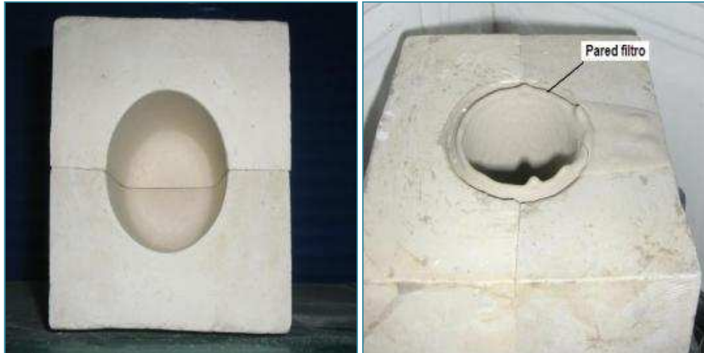
Figura 11. Molde de yeso escayola y formación de la pared del prototipo en el molde
