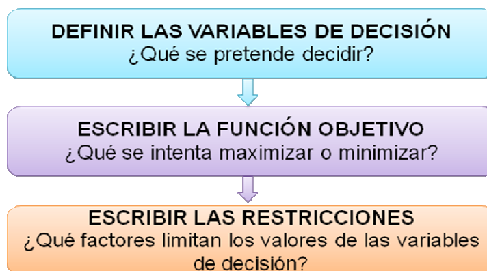
Figura 30. Pasos para la formulación del modelo de programación lineal
