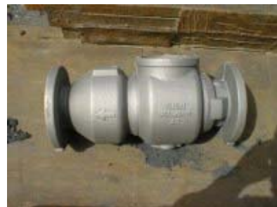
f) Vaciado con tratamiento de arena
