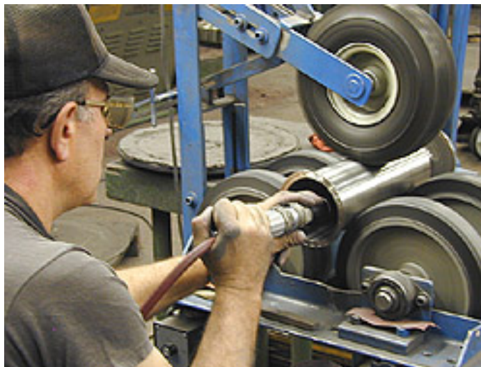
Figura 16. Desarrollo de una operación manual de rectificado interno.
