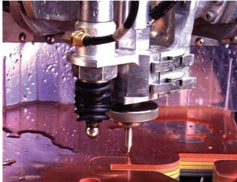
Figura 29. Desarrollo del proceso de maquinado con chorro de agua.
