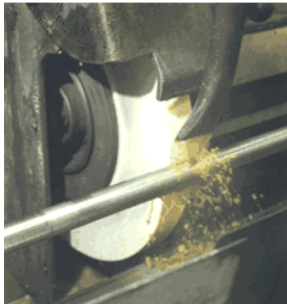
Figura 17. Desarrollo de una operación de esmerilado externo.
