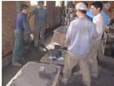
c) Ensamblando las mitades del molde
