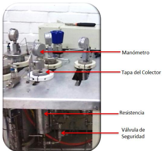
Figura 6. Tanques Colectores CS1 , CS2 y CS3 .
