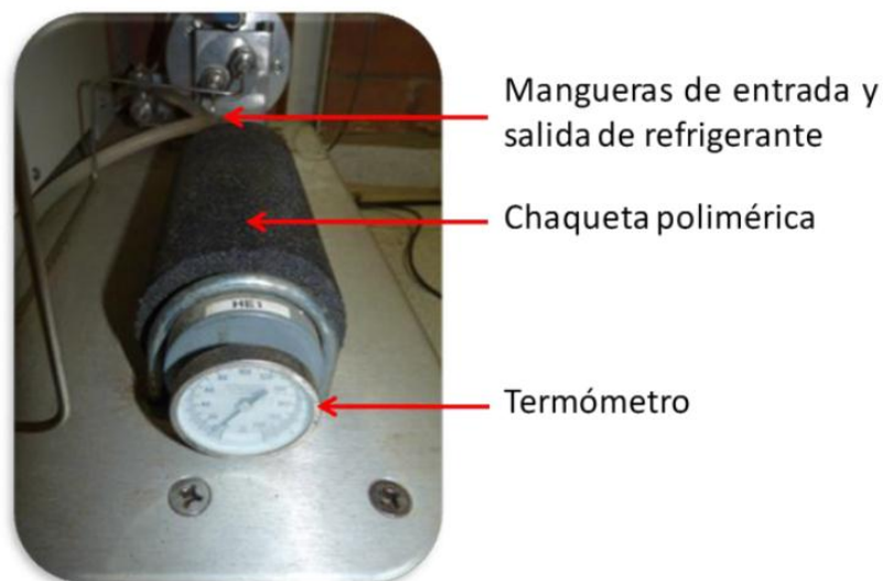
Figura 7. Intercambiador de Calor 1 (Enfriamiento).
