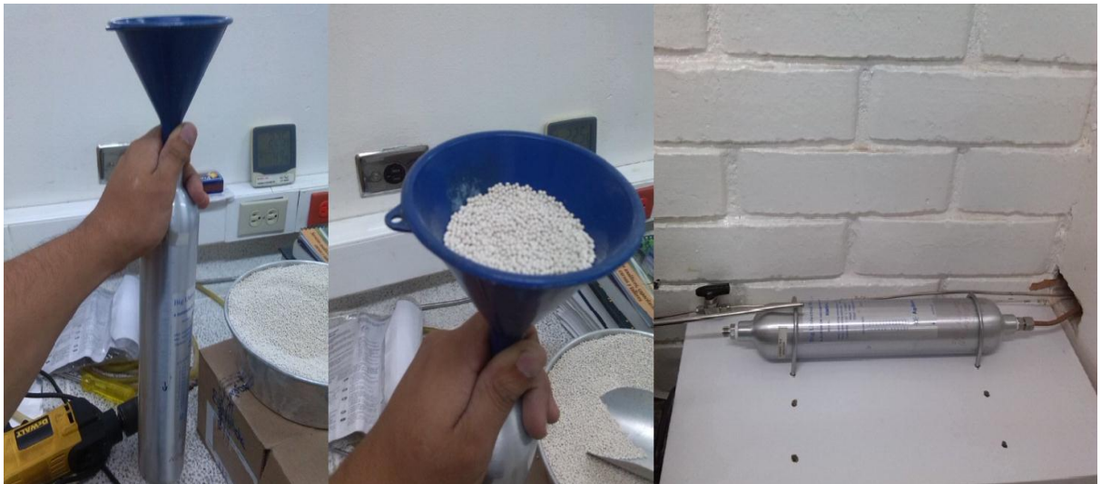
Figura 50. Instalación de Filtro Retenedor de Humedad y Extracto.
