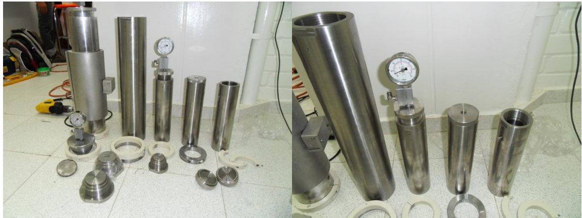
Figura 23. Tanques Nuevos Fabricados Localmente
