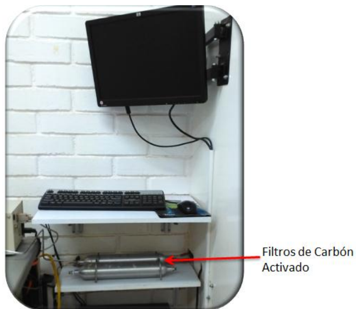
Figura 7. Filtros de Carbón Activado
