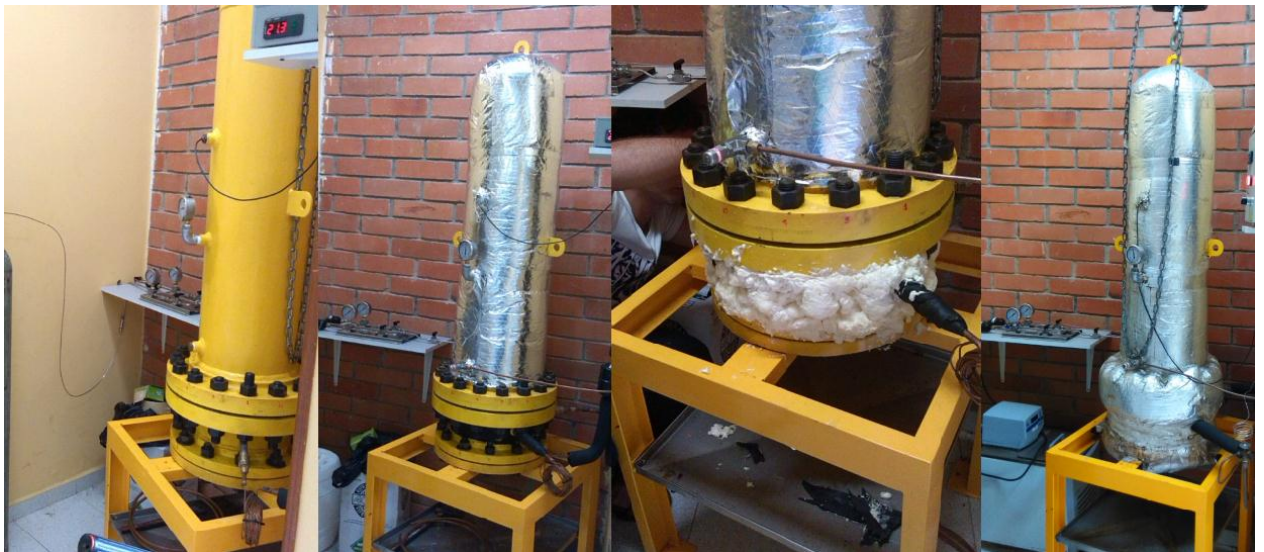
Figura 52. Instalación del Condensador
