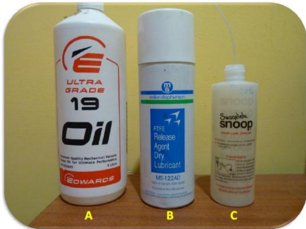
A. Aceite para lubricación de la Bomba; B. Teflón en Spray; C. Líquido para detección de Fugas.
