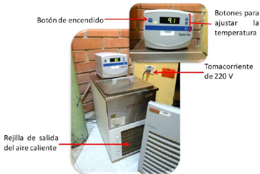
Figura 17. Puesta en Funcionamiento del Baño de Refrigeración.
