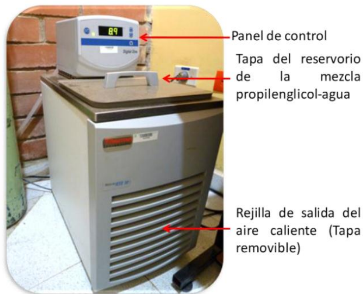
Figura 15. Baño de Refrigeración.
