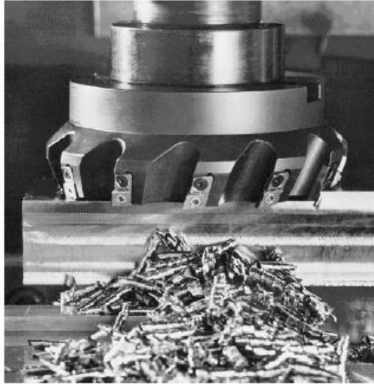
Figura 4. Cortador de fresado de careado con insertos indexables.
