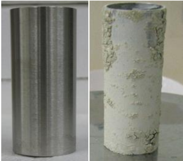
Figura J3. Registro fotográfico antes y después de realizar la prueba de Acreción utilizando como fluido el Lodo 2.
