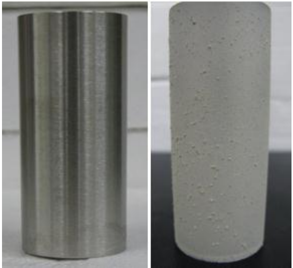
Figura J2. Registro fotográfico antes y después de realizar la prueba de Acreción utilizando como fluido el Lodo 1.
