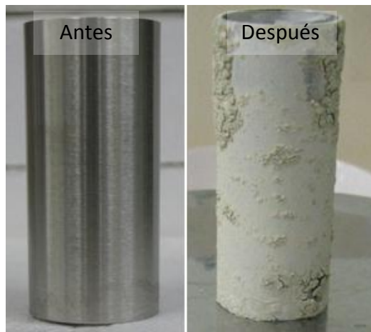
Figura 8. Registró fotográfico prueba de Acreción utilizando el Lodo 2.
