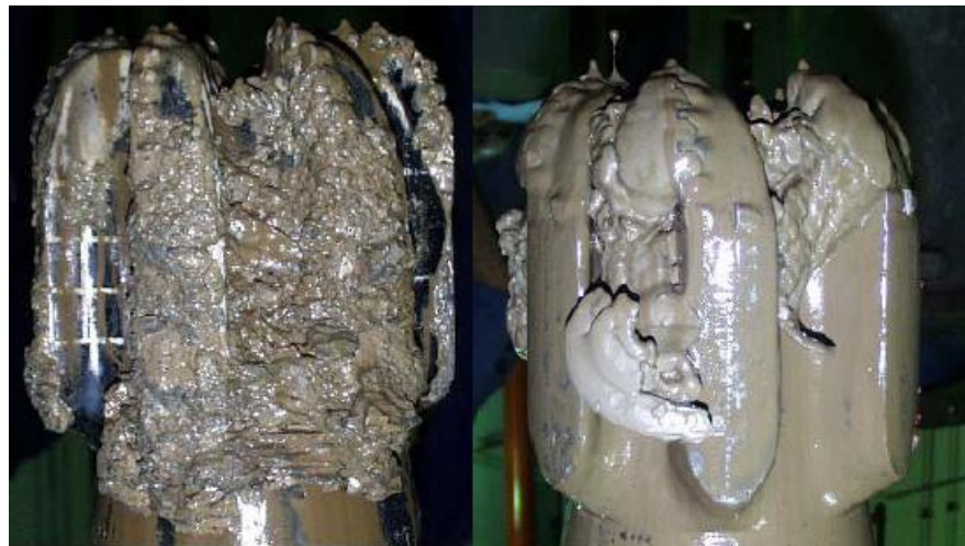
Figura 1. Imágenes de bit balling en brocas policristalinas de diamantes compactos.
