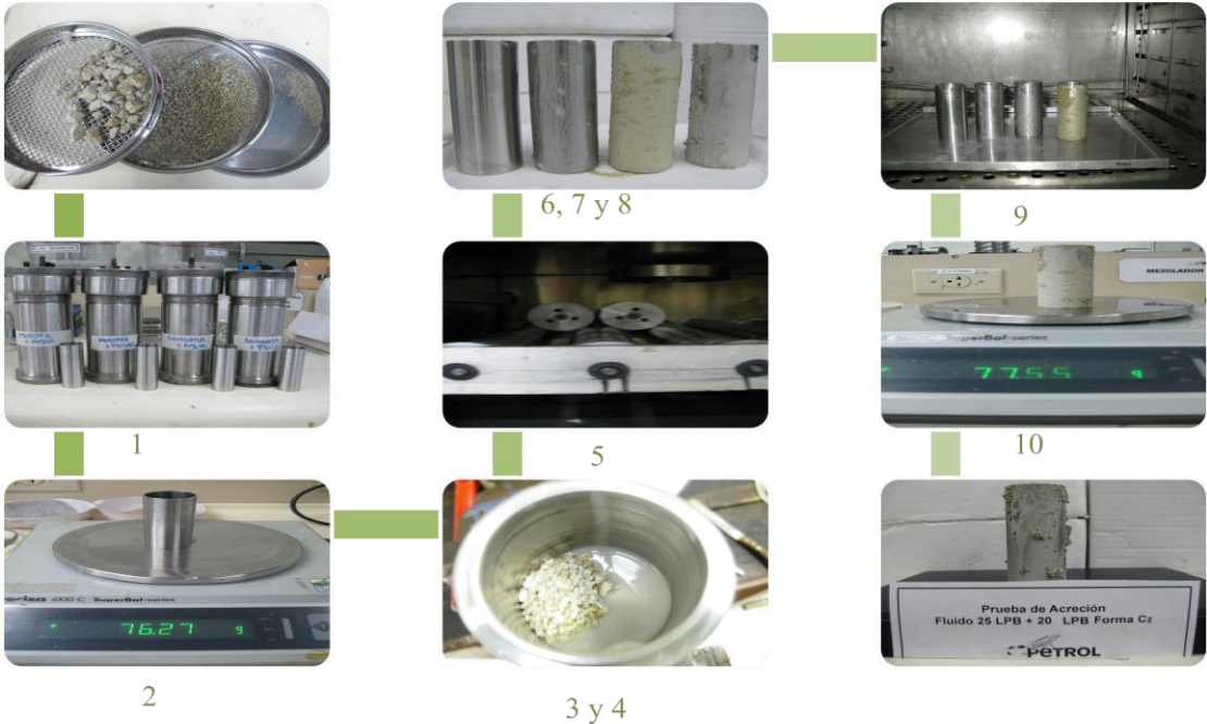
Figura F1. Diagrama del procedimiento para pruebas de acreción.
