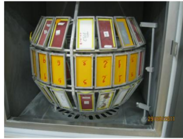
Cupones no-fisurados dentro de la cámara
