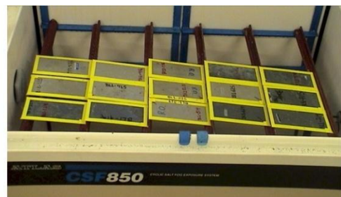
Cupones fisurados y no- fisurados dentro de la cámara
