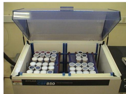
Cámara de humedad relativa adaptada para la prueba de permeabilidad al vapor de agua
