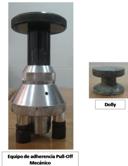
Figura 21 Equipo de adherencia Pull-Off mecánico.
