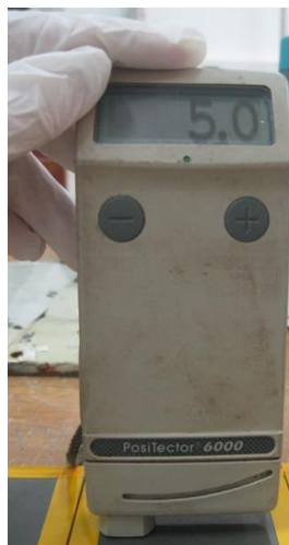
Figura 20 Equipo medidor de espesores Positector 6000
