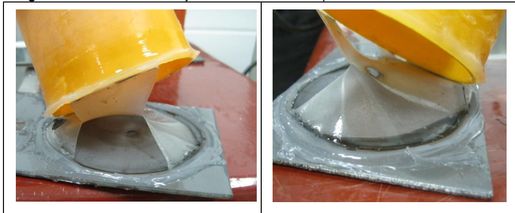
Figura 9 Resultado de ensayo de resistencia al desprendimiento catódico.
