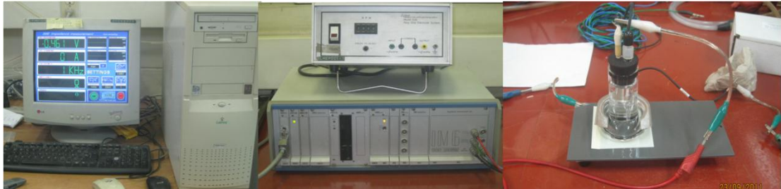
Figura 18 Equipo IM6, para ensayo de impedancia electroquímica (EIS)
