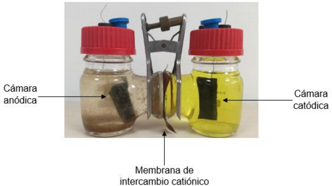
Figura 4. Montaje de una celda de combustible microbiana
