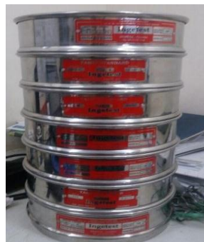
Ilustración 1. Serie de tamices usados para el análisis granulométrico del agregado fino
