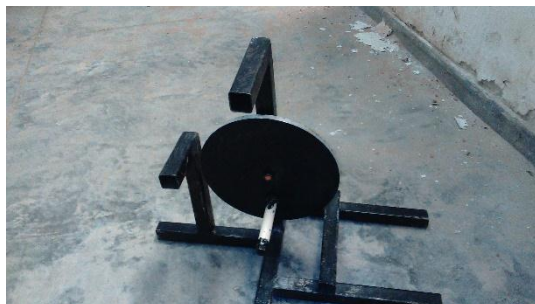
Ilustración 17. Montaje utilizado para el ensayo de desgaste.
