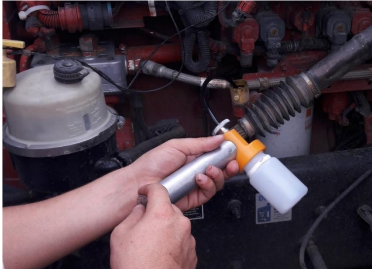
Figura 17. Enroscar frasco en la bomba de vacío.
