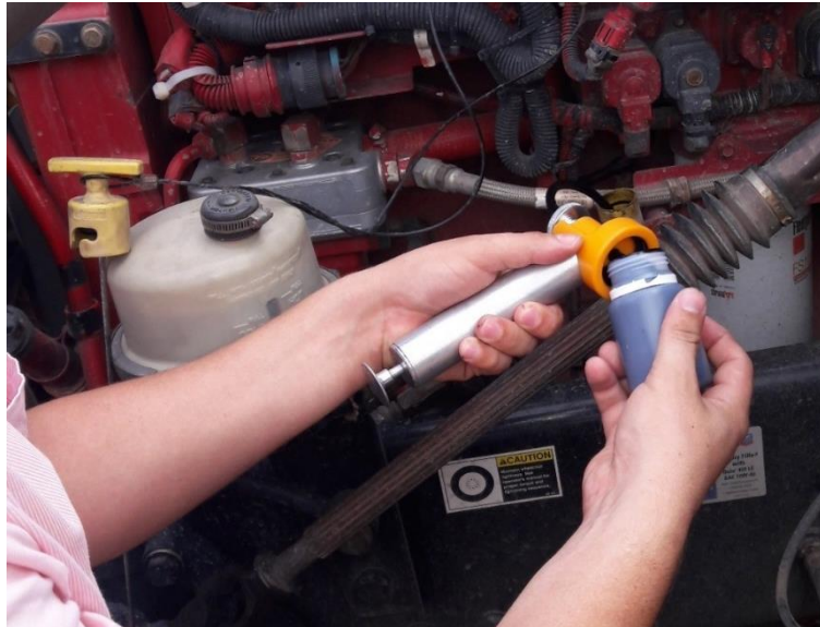
Figura 19. Retirada del frasco de muestreo.
